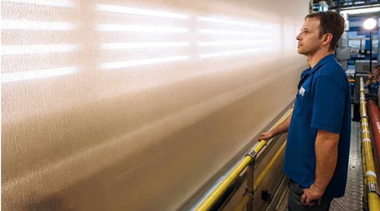
Abbildung 27: Sichtprüfung textiler Rollenware. Foto: © Verseidag-Indutex GmbH
