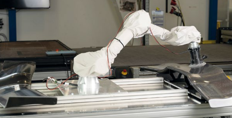
Abbildung 25: Prototyp des autonomen Schleifroboters. Foto: © Moritz Lennartz, Institut für Textiltechnik der RWTH Aachen University
